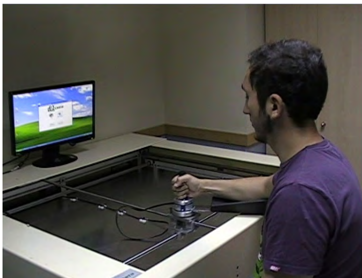
Figura 2. Segunda versión de la plataforma PHYSIOBOT, con estructura mecánica de diseño propio
