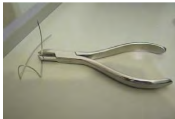
Figura 3. Dobras no fio de aço inox realizada com alicate 201.
