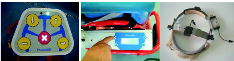
Figura 2. Consola de pulsadores de dirección para conducción del vehículo, panel de educador para establecer parámetros de configuración y sistema ENLAZA para la conducción del vehículo con los movimientos de cabeza
