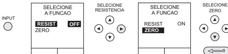
A fim de assegurar medições precisas, recomenda-se que o procedimento de zerar (que compensa a resistência dos fios de prova), é efetuado antes de realizar o teste.
