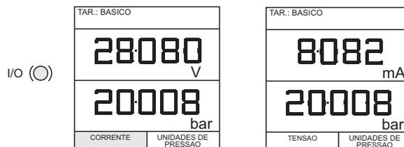
Na primeira vez em que o instrumento for alimentado com corrente, de acordo com as telas de inicialização e de Pressão Máxima, ele o fará no modo **BASICO** com a tela principal exibindo tensão na área de display de medição pressão na área de display da fonte. Para mudar para **Corrente** como medição, pressione **F1** conforme mostrado. Da mesma forma, **F1** para retornar para **Tensão**.
