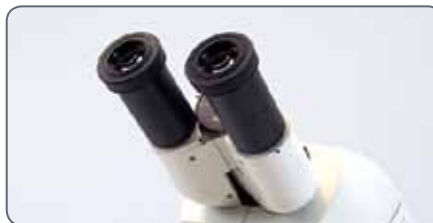
Tipo 1: Canhão de visualização Leica EZ com oculares integradas.
