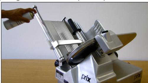
Utilizando um spray ou um pincel com o lubrificante em sachê, lubrifique a guia deslizante do apoio do produto.
