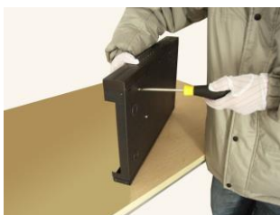
④ apertar o parafuso do disco rígido
