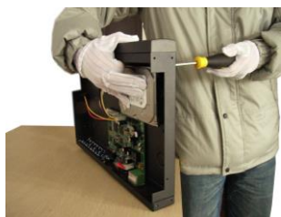
③ apertar o parafuso do disco rígido
