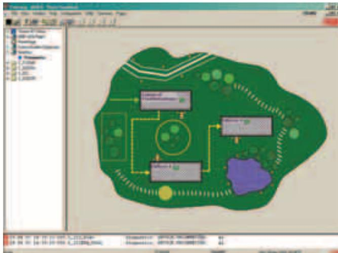
A estação operadora do SD-View 2000 (computador pessoal) permite que informações da instalação sejam recebidas e que os disjuntores e seus relés relacionados sejam controlados. Particularmente, é possível:
