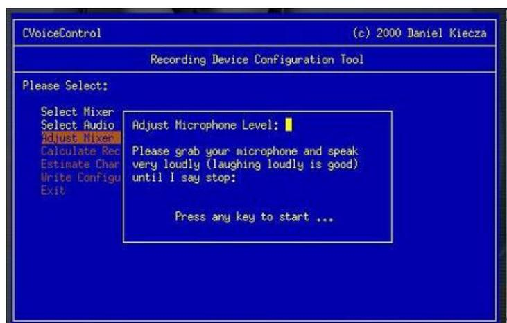
Ao pressionar qualquer tecla, obtêm-se as telas ilustradas abaixo, momento em que se deve falar em voz alta diante o microfone (risadas altas colaboram para a avaliação do volume no *Mixer*). Esse procedimento é realizado para encontrar o melhor nível de volume de seu microfone, no ambiente que se encontra:
