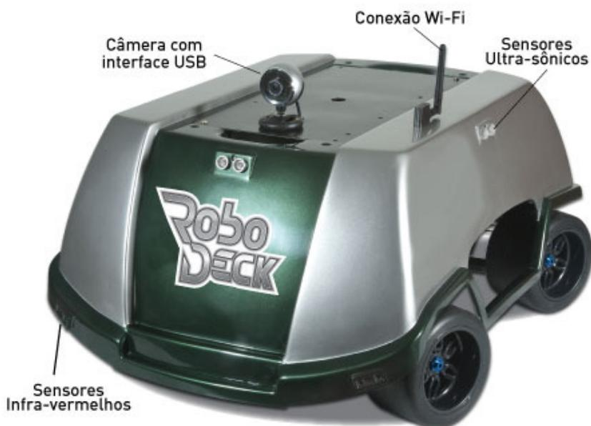
**Figura 15 – Robô móvel *RoboDeck* da empresa Xbot**
