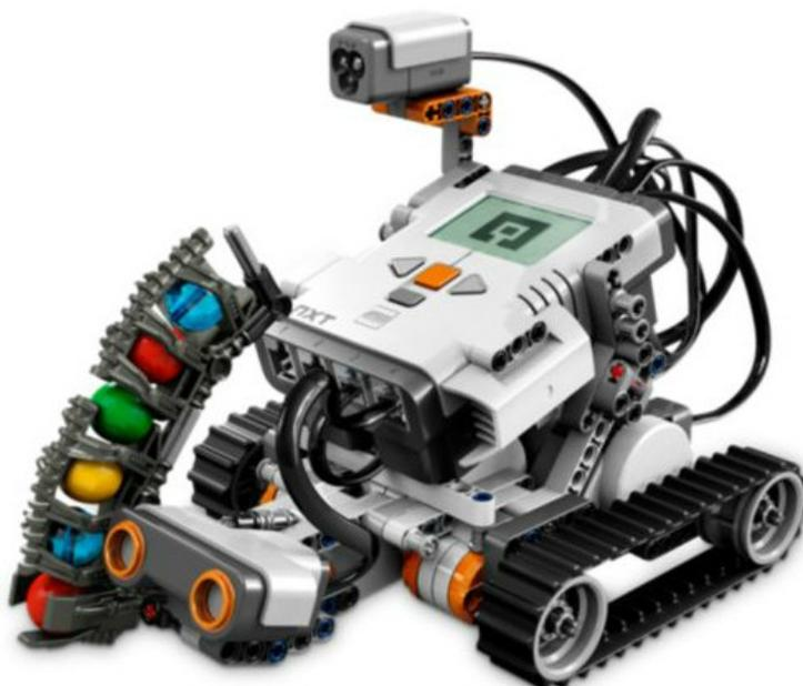
**Figura 13 – Robô móvel *Mindstorms* NTX 2,0 da empresa LEGO**
