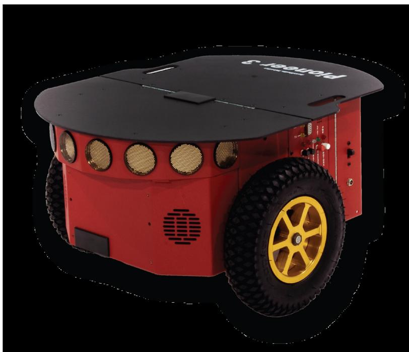
**Figura 14 – Robô móvel Pioneer 3 da empresa MobileRobots**
