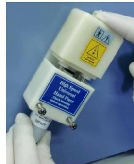
3.2. Encaixe o conector do manípulo aplicador na sua entrada localizada na lateral do equipamento.
