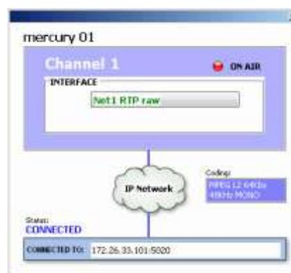
**frequência de amostragem** (48KHz, por exemplo) e o **modo** (Mono, Stereo, Dual, Jstereo ou MS Stereo).
