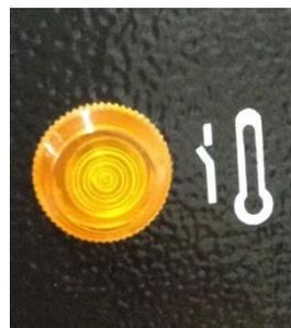
Neste momento, não desligue o equipamento, pois as ventoinhas precisam ficar funcionando para acelerar o processo de esfriamento. Aguarde até que o indicador apague após
