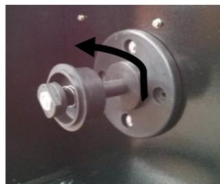
Encaixe o rolo de arame sobre o suporte e reponha o apoio livre e a porca apertando-a. Observe que o rolo deve estar devidamente encaixado; Verifique se a direção de rotação do arame está no sentido anti-horário;
