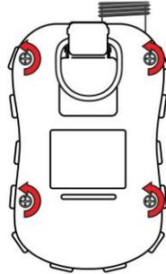
6. Segure o ToxiRAE Pro CO<sub>2</sub> voltado para baixo e separe a tampa traseira da parte frontal puxando a parte superior e inclinando-a sem soltar o cabo que conecta as duas metades.
