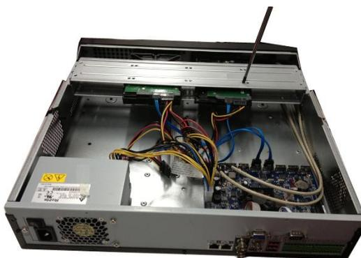
2. Coloque o suporte de HDD a HDD no chassi e, em seguida, alinhe os quatro parafusos para os quatro furos no HDD. Utilize a chave de fenda para fixar os parafusos e para fixar o HDD no suporte de HDD
