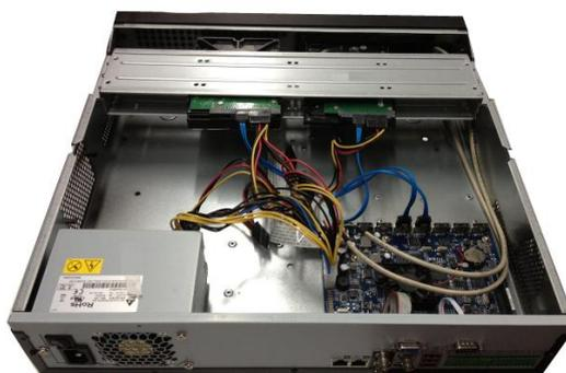
3. Conecte-o ao conector do cabo de dados do HDD à placa mãe e à porta HDD respectivamente. Solte o cabo de alimentação do chassi e conecte a outra extremidade do cabo de alimentação à porta de HDD.
