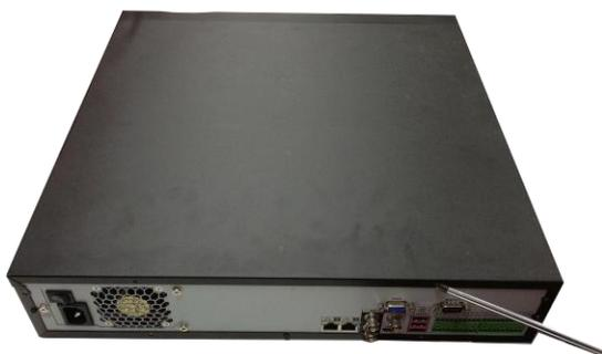
1. Utilize a chave de fenda para afrouxar os parafusos do painel traseiro e, em seguida, retire a tampa da frente.
