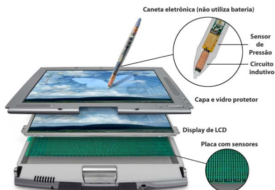
Figura 2 – Esquemático do hardware de escrita
