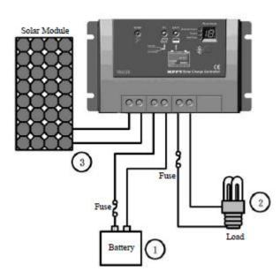
Preparar as ferramentas necessárias, é de realçar a correcta utilização de todos os equipamentos previamente dimensionados para o sistema autónomo pretendido. Sugerimos a escolha de cabos apropriados para garantir uma densidade de corrente <4A/mm2, de maneira a reduzir a queda de tensão do cabo.
