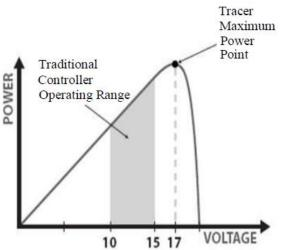
Os controladores tradicionais não operam na zona Vmp dos módulos solares, sendo a energia desperdiçada utilizada para carregar a bateria e as cargas do sistema de energia. Quanto maior for a diferença entre a tensão da bateria e o Vmp do módulo, mais energia é desperdiçada. A tecnologia MPPT opera sempre na zona Vmp resultando num menor desperdício de energia.
