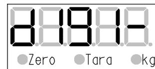
Se acende normalmente mas não consegue terminar a inicialização, a tensão de alimentação é insuficiente. Checar tensão da bateria e recarregar se necessário.
