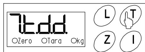
Pressionar a tecla T para escolher o valor do Tempo para Desligar Display. Com zero o display nunca é desligado.
