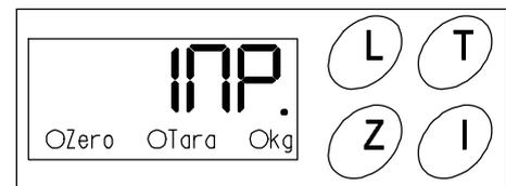
Pode-se imprimir o ticket totalizador a qualquer momento. Para isso, deve-se manter a tecla I pressionada por mais de 2 segundos. Não é necessário ter carga sobre a plataforma da balança e nem que ela esteja estável.
