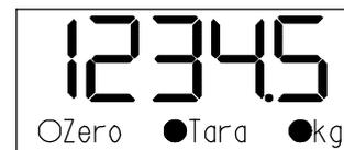
O peso ou a quantidade são codificados em ASCII com ponto decimal. O caractere de retorno de carro é 0x0D (hexadecimal). O envio da string é interrompido em caso de falha significativa. O bit de sobrecarga é setado quando há sobrecarga (traços superiores) ou sub-carga (traços inferiores) de peso ou extrapolação do conversor analógico digital (Erro 5).
