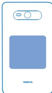
**⚠️ Aviso:** Certifique-se de que não haja nada entre o carregador e o dispositivo. Não cole itens como adesivos na superfície do dispositivo, próximo à área de carregamento.
