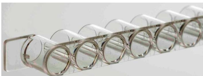
**Figura 1. Plataforma CLARTStrip<sup>®</sup> – CS na forma de uma tira de 8 alvéolos**
