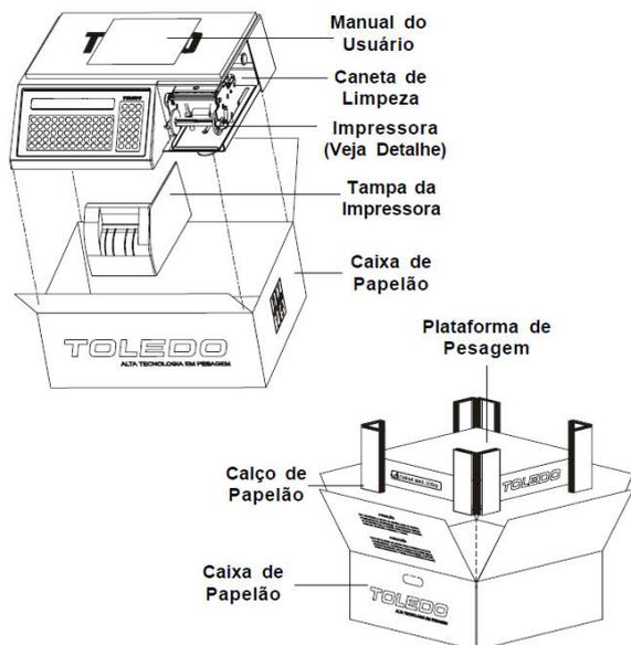
Ao abrir a caixa de papelão você verificará que a 4 W Due está totalmente envolvida por poliuretano expandido. Sua plataforma é embalada em outra caixa (conforme figura ao lado esquerdo), formando o conjunto. Este processo de embalagem evita que a 4 W Due se movimente na caixa, protegendo-a contra impactos durante o transporte.
