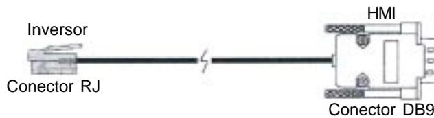
**Figura 8.12** - Cabo CAB-RS para HMI-CFW08-RS
