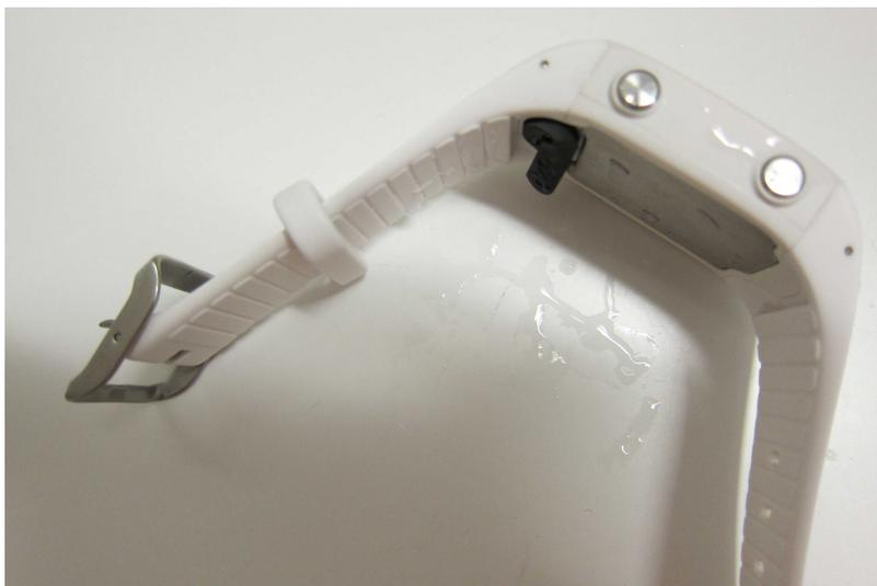
Quando utilizar a porta USB, verifique se não há humidade, cabelos, poeira ou sujidade na superfície vedante. Limpe a sujidade com suavidade. Poderá utilizar um palito para remover pelos, pó ou outra sujidade da cavidade do conector. Para evitar quaisquer riscos, não utilize ferramentas aguçadas durante a limpeza.
