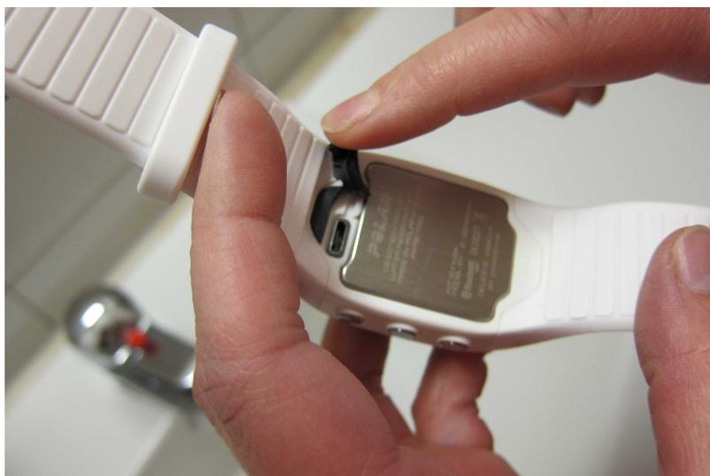
2. Enxague a porta USB com água morna da torneira. A porta USB é resistente à água e pode enxaguá-la em água corrente sem danificar os componentes eletrónicos.
