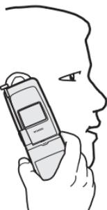
Este dispositivo possui uma antena fixa e uma antena externa localizada em cima do telefone com o *flip* fechado. Segure o aparelho com a antena apontada para cima, sobre o seu ombro.
