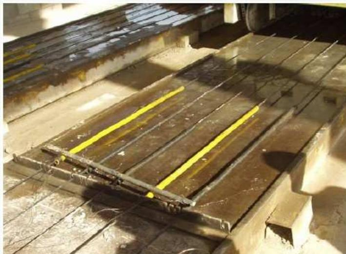
FIGURA 19 – Proteção das cordoalhas durante a aplicação do desmoldante (PETRUCELLI, 2009)
