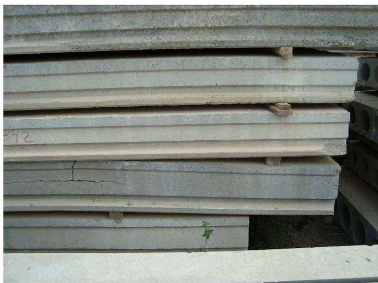
FIGURA 32 - Lajes com fissuras devido a estoque com calços desalinhados (PETRUCELLI, 2009)
