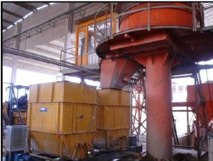
FIGURA 21 – Usina de produção de concreto e caçambas posicionadas no carrinho de transporte (PETRUCELLI, 2009)
