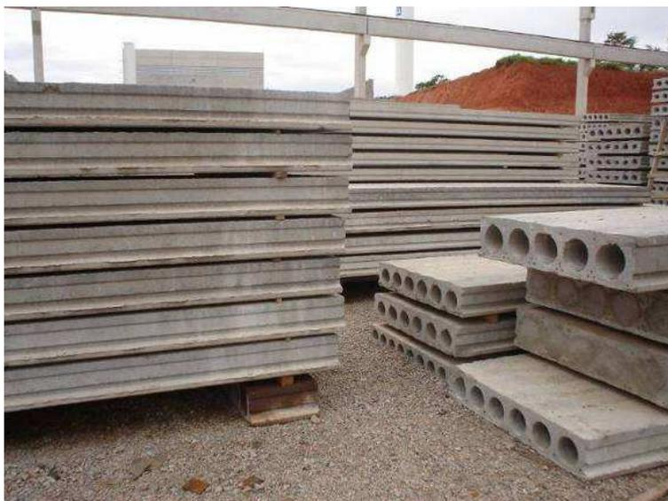
FIGURA 31 - Pilha de lajes estocadas com calços alinhados (PETRUCELLI, 2009)
