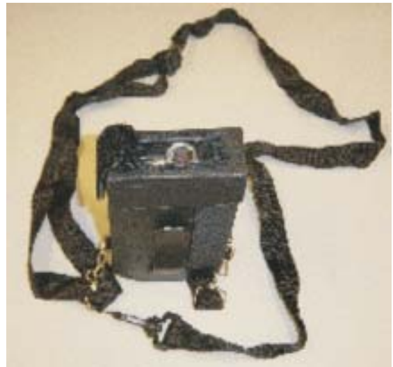
FIGURA 3 – O CDI em sua capa, mostrando o grampo (no centro) e as alças para transporte, o elástico para prendê-lo à mão do operador (à direita) e a abertura conversível superior para a câmera digital.
