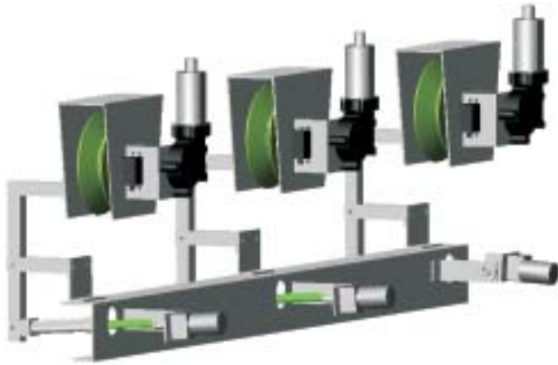
FIGURA 2. Uma configuração de mecanismo para transposição de torres (robô com 3 rodas).
