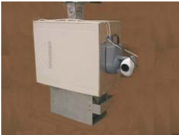
FIGURA 7 – Foto com detalhes da caixa onde está fixada a câmera PTZ.
