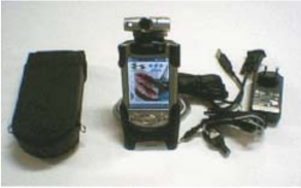
FIGURA 2 – Componentes do CDI: “Pocket PC” com o aplicativo de inspeção, câmera digital na jaqueta de expansão, base de comunicação, fonte de alimentação, cabos e a capa protetora.
