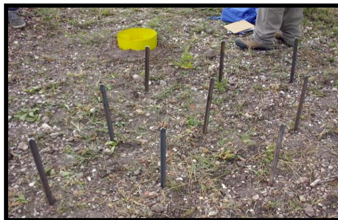
Figura 4: Disposição dos pinos de erosão e bandeja de salpicamento (amarela) em um dos sítios experimentais instalados na área de estudo.
