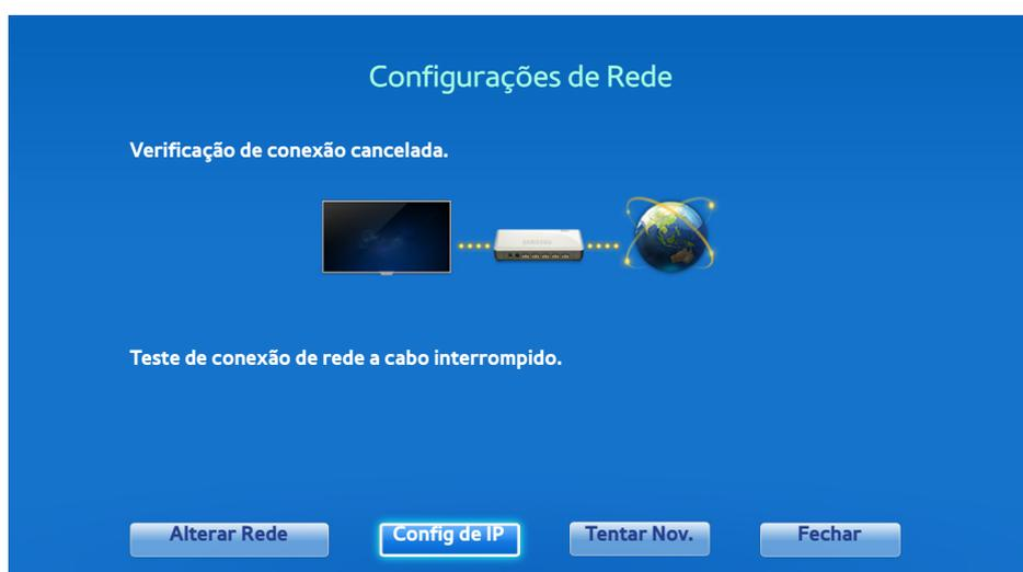
3. Na tela **Config de IP**, defina **Config de IP** como **Digitar manualmente**, digite o **Endereço IP**, **Máscara Sub-rede**, **Gateway** e os valores de **Servidor DNS** e, em seguida, selecione **OK**.
