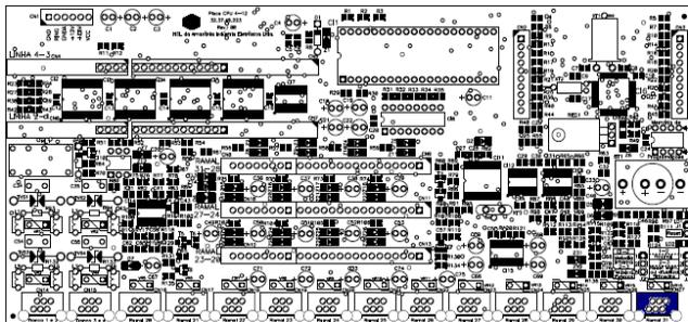
**DESLIGAR A CENTRAL E POSICIONAR O JUMPER J3 NA POSIÇÃO 2-3**
