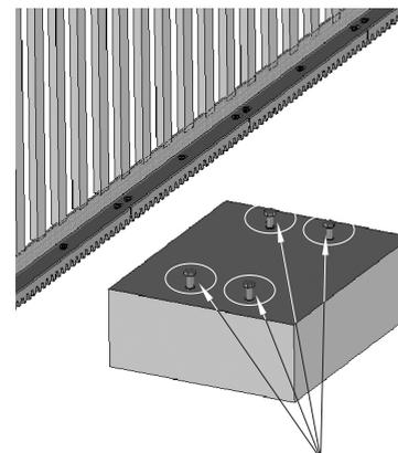
FUROS DE FIXAÇÃO DO AUTOMATIZADOR
