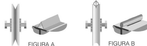
3. Verifique se a folha do portão não emperra no movimento de abertura e fechamento. O trilho de deslizamento do portão deverá ser perfeitamente retilíneo, nivelado, desobstruído periodicamente de qualquer elemento ou sujeira que dificulte o deslizamento das roldanas em toda sua extensão, como mostra a figura abaixo.
