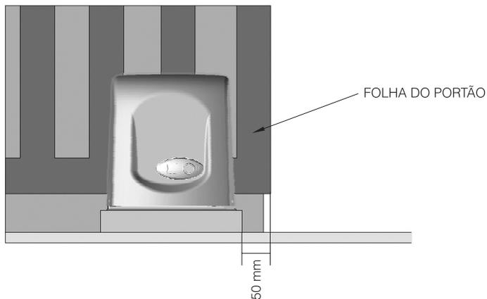
**4º Passo:** Faça o pré-alinhamento do automatizador ao portão, posicionando a cremalheira sobre a engrenagem e encostando o conjunto ao portão. Em seguida, marque os furos de fixação no piso ou base de concreto.
