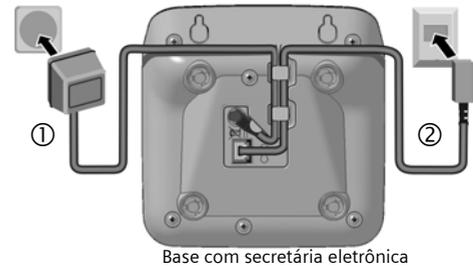
**Primeiramente, conecte a fonte de alimentação com o cabo ① e depois o cabo de telefone com o plugue ② como indicado.** Passe os cabos pelas canaletas adequadas. Os dois cabos devem estar **sempre conectados**.
