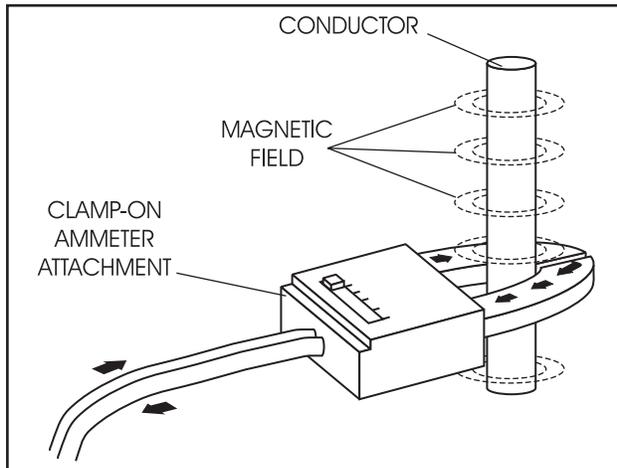
*Figure 2-2. – Clamp-On Ammeter*
