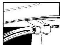
Quando você não quiser mais usar a drenagem de água permanente, desconecte a mangueira do aparelho.
