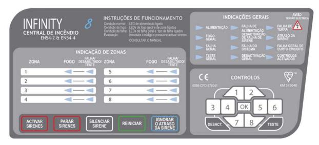
Quando a central de alarme de incêndio Infinity 8 está em alarme por um alarme um Detector ou botoneira localizada numa zona que ainda não está em alarme a central irá:
