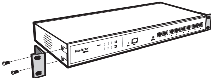
Instalación de los soportes en la central
