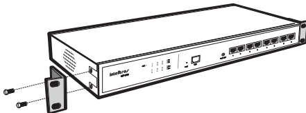
Instalação dos suportes na central
