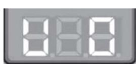
Se várias falhas foram detectadas somente o código da última ocorrência será exibido. Pressione qualquer tecla de função ou gire qualquer botão para remover a indicação de falha do display.
