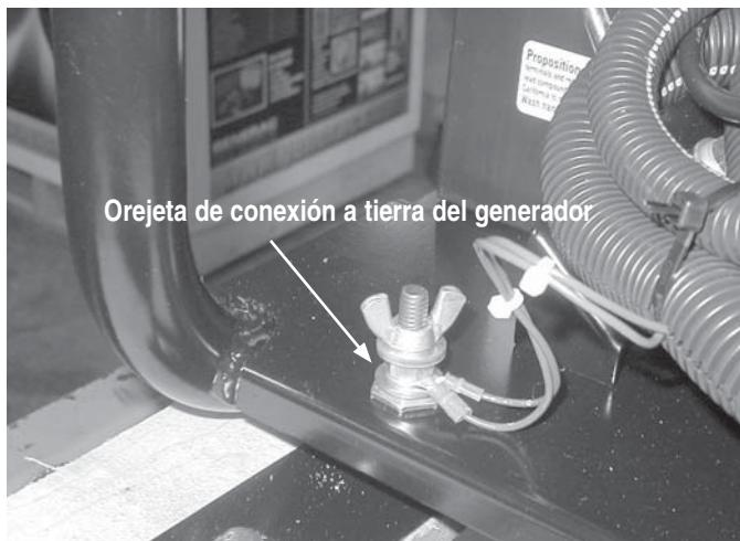
La conexión a tierra adecuada del generador ayudará a evitar descargas eléctricas en el caso de que exista una condición de falla a tierra en el generador o en los dispositivos eléctricos conectados. La conexión a tierra adecuada también ayuda a disipar la electricidad estática, la cual se acumula frecuentemente en dispositivos no conectados a tierra.
