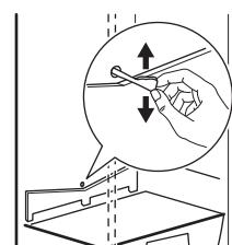
La escarcha se elimina automáticamente del evaporador del frigorífico cada vez que se detiene el compresor, durante el funcionamiento normal. El agua de la descongelación se descarga por un canal hacia un recipiente especial situado en la parte posterior del aparato, sobre el motor compresor, desde donde se evapora.
