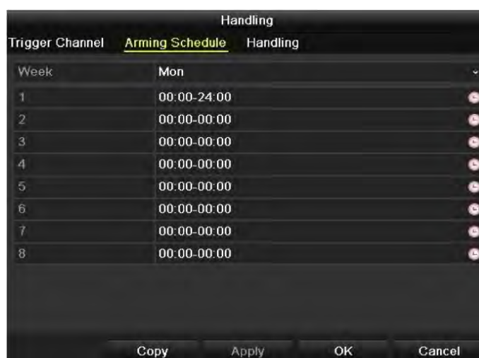
Figura 8.4 Definir o tempo forçado da deteção de movimento
