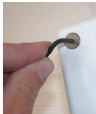
Aperte a cabeça dos parafusos com a chave allen de 3mm fornecida. **A sua fiação deve estar nivelada e não achatada apertando demasiado o parafuso.**
