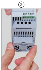
Liberação das travas para remoção do ventilador
