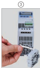
Desconexão do cabo
