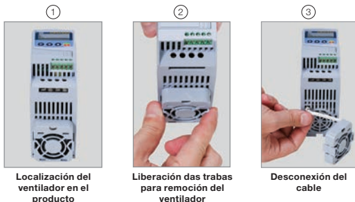
Figura 6.1: Retirada del ventilador del disipador
