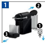
Débrancher la machine et retirer le réservoir à eau et l'unité de maintenance.
