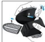
Para ensamblar el soporte para tazas y la bandeja de goteo: retire la rejilla, colóquelas uno al lado del otro y coloque la bandeja de goteo en el soporte para tazas.
