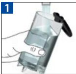
Coloque un recipiente debajo de la salida del café y presione el botón Lungo para limpiar la máquina. Repita esta operación 3 veces.
