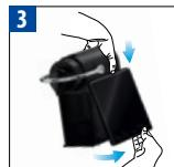
Presionar con el pulgar y empujar con la otra mano para desenganchar el panel lateral como se muestra en la imagen.
