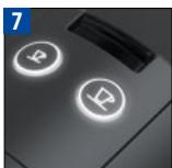
**■ NOTA:** presione el botón Espresso (40 ml) o el Lungo (110 ml). La preparación se detendrá automáticamente. Para detener la salida del café o llenar completamente la taza, presione nuevamente.
