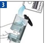
Remplissez le réservoir d'eau de 0.5 L/16.9 oz d'eau et ajoutez le liquide de détartrage Nespresso.
