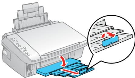
**3** Gire o protetor do alimentador de papel para a frente. Aperte a guia lateral e deslize-a para a esquerda.
