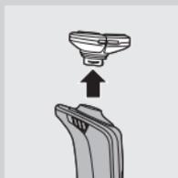
**2** Insérez la languette de la nouvelle unité de rasage dans la fente du rasoir prévue à cet effet (1). Fixez ensuite l'unité de rasage sur le rasoir en faisant glisser le taquet vers le bas (2) (clic).
