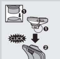
**2** Stecken Sie die Führung der neuen Schereinheit in den Schlitz oben am Rasierer (1). Drücken Sie die Schereinheit dann nach unten (2), so dass sie mit einem "Klick" auf dem Rasierer einrastet.
