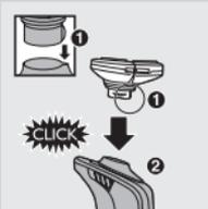
**2** Inserte el saliente de la nueva unidad de afeitado en la ranura de la parte superior de la afeitadora (1). Luego presione la unidad de afeitado hacia abajo (2) para fijarla a la afeitadora (“clic”).
