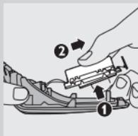
**8** Ziehen Sie die Drähte aus der Motoreinheit und nehmen Sie den Akku heraus.
