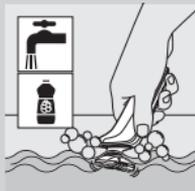
► Pour un nettoyage en profondeur, mettez le rasoir en marche et plongez l'unité de rasage dans une eau chaude et savonneuse pendant 30 secondes. Vous pouvez également utiliser de l'alcool pour nettoyer l'unité de rasage.
