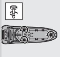
**7** Svitare le 3 viti all'interno del rasoio e rimuovete il coperchio posteriore.
