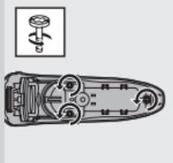
**7** Lösen Sie die drei Schrauben innen im Rasierer und nehmen Sie die Rückseite ab.
