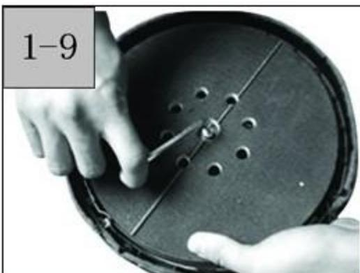
**Atenção :** Só instale o bloco de velcro especificado na máquina.
