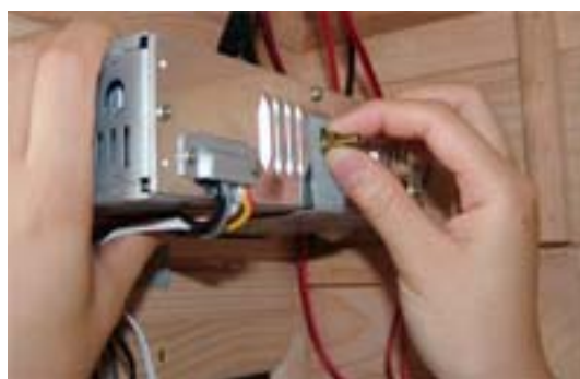
FIG-15.3 Fije el reproductor de CD con tornillos
