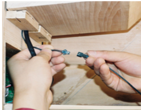
FIG-21 Conecte el cable del sensor
