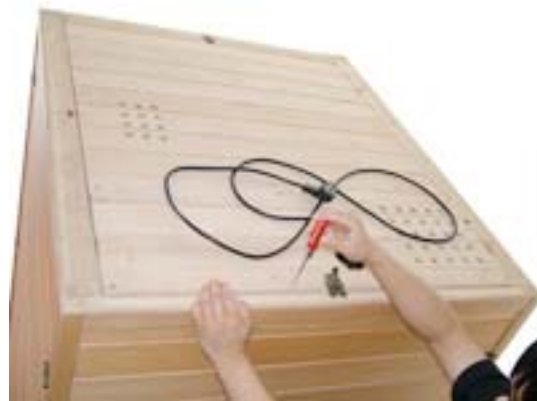
FIG-26 Fije el panel exterior con tornillos
