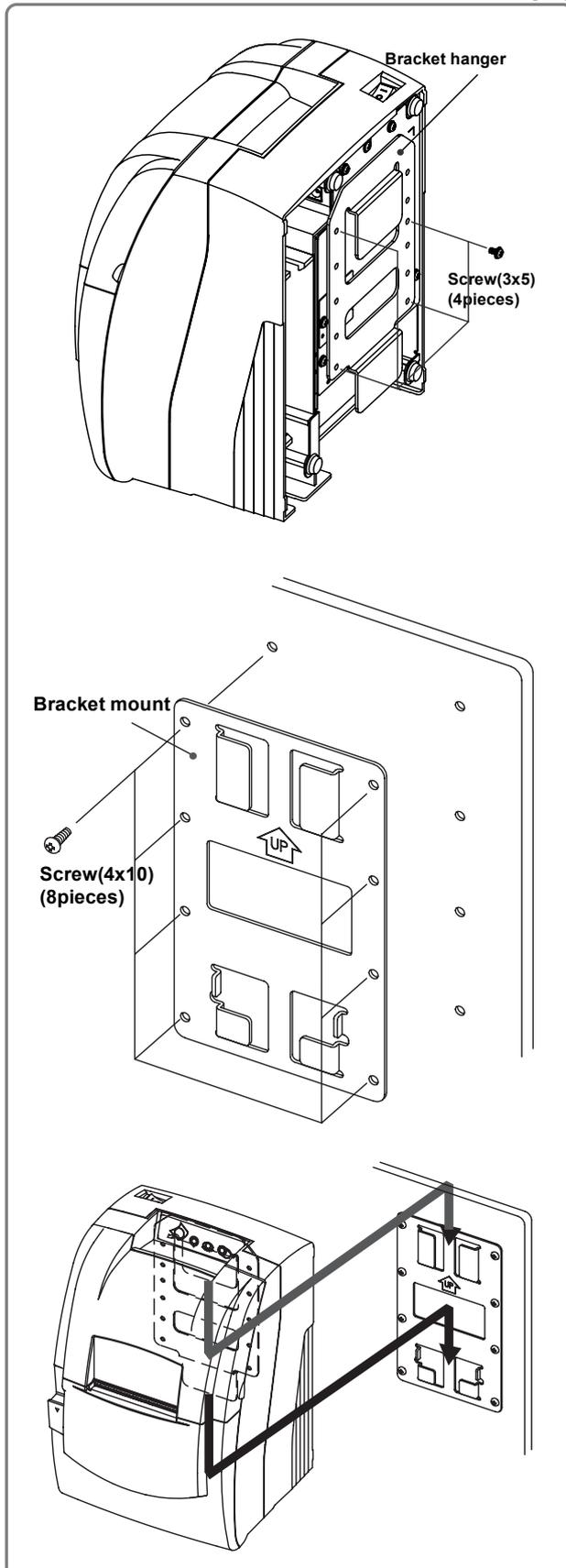
1) Vire o aparelho ao contrário e fixe o suporte suspensor à sua base com quatro parafusos.
