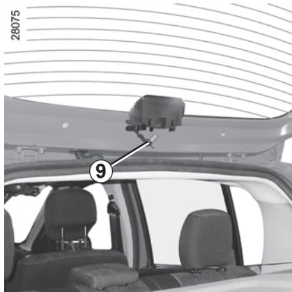
Gire o porta-lâmpadas 9 um quarto de volta, desencaixe e retire a lâmpada.
