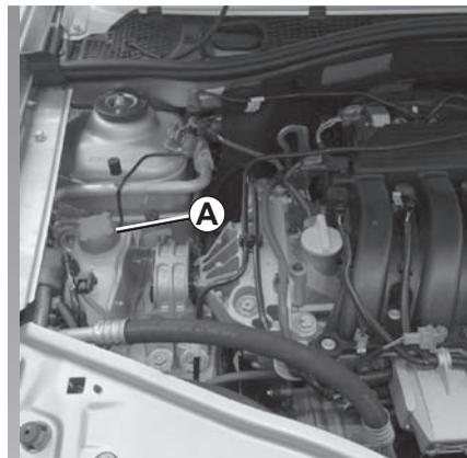
**Reservatório de gasolina para veículos com sistema Hi-Flex (gasolina e Etanol hidratado) A**
