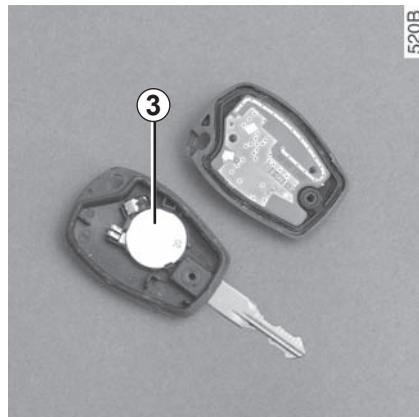
Substitua a bateria **3**, observando a polaridade gravada na tampa.
