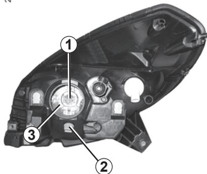
Extraia o conector da lâmpada **1**. Desengate a mola e retire a lâmpada.
