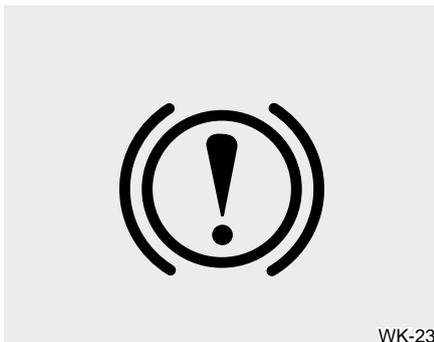
Verifique a luz de advertência do freio girando o interruptor de ignição para a posição “ON” (não dê partida no motor). Esta luz acenderá quando o freio de estacionamento for acionado com o interruptor de ignição na posição “START” ou “ON”.
