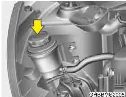
Com o veículo sobre uma superfície nivelada, verifique periodicamente o nível de fluido no reservatório da direção assistida. O nível do fluido deve estar entre as marcas "MAX" e "MIN" existentes na lateral do reservatório em temperatura normal.
