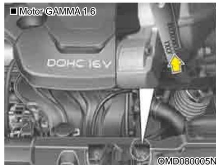
O número do motor está estampado no bloco do motor, conforme mostrado pela figura.
