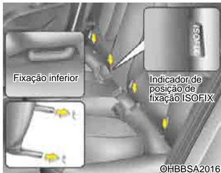
Na parte inferior de cada lado dos encostos dos bancos traseiros encontram-se etiquetas ISOFIX. Essas etiquetas indicam a posição das fixações inferiores para os sistemas de proteção para crianças existentes.
