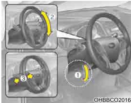
Para alterar o ângulo de inclinação do volante de direção, puxe a alavanca de liberação da trava (1) para baixo, ajuste o volante na altura (2) e profundidade desejadas (se equipado) (3) e, em seguida, puxe a alavanca de liberação da trava para cima para travar o volante de direção. Certifique-se de ajustar o volante de direção na posição desejada antes de dirigir.
