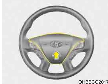
Para acionar a buzina, pressione o símbolo correspondente no volante de direção. Verifique a buzina regularmente, a fim de certificar-se que ela funcione adequadamente.
