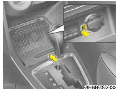
A tomada de força foi projetada para fornecer energia elétrica para telefones celulares ou outros equipamentos projetados para funcionar com o sistema elétrico do veículo. Os equipamentos deverão consumir menos que 15 amperes com o motor em funcionamento.
