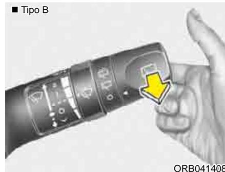
Na posição "OFF" (O), puxe suavemente a alavanca em sua direção para esguichar o líquido do lavador no para-brisa e acionar os limpadores por 1 a 3 ciclos.
