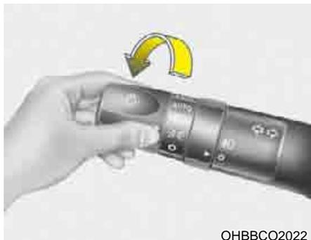
Quando o interruptor de iluminação está na posição de luz de posicionamento, as lanternas traseiras, a luz de placa de licença e as luzes do painel de instrumentos estão acesas e o indicador das lanternas traseiras acende.
