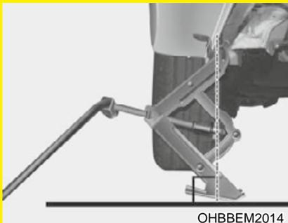
**Para reduzir a possibilidade de ferimentos, certifique-se de usar somente o macaco original fornecido com seu veículo e as posições corretas para apoio do macaco. O ponto de levantamento no veículo e ponto de apoio do macaco no solo devem ficar em uma linha vertical em relação ao solo. Nunca use outras partes do veículo como ponto de apoio para o macaco.**
