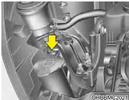
O reservatório é translúcido de modo que você possa verificar o nível com uma inspeção visual rápida.
