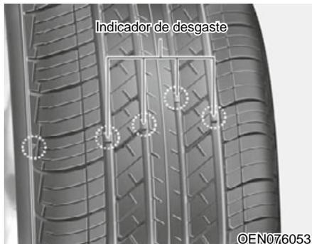
Se um pneu for gasto uniformemente, um indicador de desgaste aparecerá como uma faixa sólida atravessando a banda de rodagem. Isso mostra que resta menos de 1,6 mm da banda de rodagem no pneu. Substitua o pneu quando isso acontecer.
