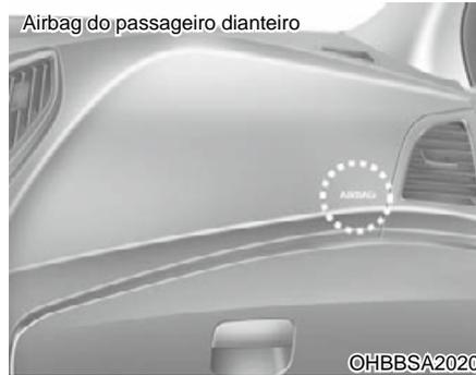
A finalidade do SRS Airbag é oferecer ao motorista e/ou ao passageiro dianteiro uma proteção adicional, além da proporcionada pelo cinto de segurança, no caso de um impacto frontal suficientemente severo.
