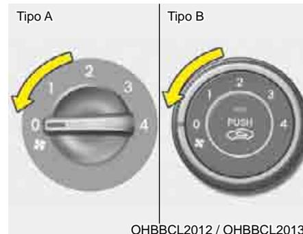
Para desligar os ventiladores, gire o seletor de controle de velocidade do ventilador para a posição "0".
