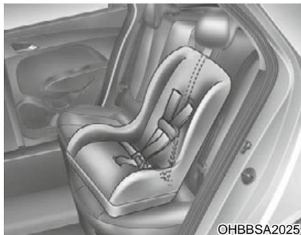
1. Passe a cinto do sistema de proteção para crianças por cima do encosto do banco. Para veículos com apoio de cabeça ajustável, passe a cinto de fixação por baixo do apoio de cabeça e entre as hastes do apoio ou por cima da parte superior do encosto do banco.
