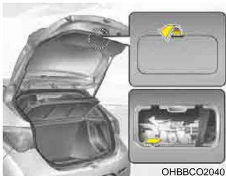
Seu veículo é equipado com uma alavanca de liberação da tampa do porta-malas para caso de emergência, que está localizada na parte inferior da tampa do porta-malas.
