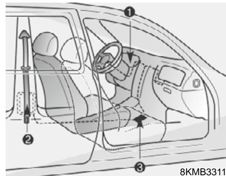
O sistema de pré-tensionamento do cinto de segurança é composto basicamente pelos componentes a seguir, cuja localização é mostrada na ilustração:
