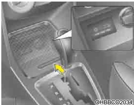
Caso o seu veículo possua entradas AUX e USB, pode-se utilizar a porta AUX para conectar dispositivos de áudio, ou a porta USB para conectar um dispositivo USB. Um iPod® pode ser conectado com um cabo de conexão Hyundai para iPod.
