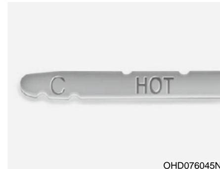
3. Certifique-se que o nível do fluido esteja dentro das marcas "HOT" (quente) na vareta de nível. Se o nível estiver abaixo, adicione o fluido especificado pelo bocal de enchimento. Se o nível do fluido estiver acima, drene um pouco de fluido pelo bujão de dreno.
