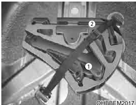
O macaco e a chave de roda estão guardados no compartimento de bagagem. Levante a tampa do compartimento de bagagem para alcançar esses equipamentos.
