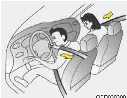
Seu veículo está equipado com pré-tensor dos cintos de segurança nos bancos do motorista e do passageiro dianteiro. A finalidade do pré-tensor é garantir que os cintos de segurança se ajustem ao corpo dos ocupantes em certas colisões frontais. O pré-tensor do cinto de segurança pode ser ativado em acidentes onde a colisão frontal é suficientemente grave.
