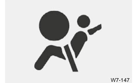
A finalidade da luz de advertência do airbag no painel de instrumentos é alertar o motorista sobre um possível problema com o sistema do airbag (SRS).
