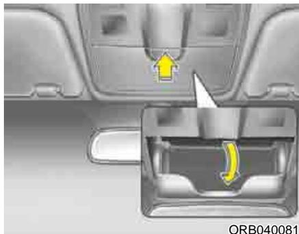
Para abrir o porta-óculos, pressione a tampa e o porta-óculos abrirá lentamente. Coloque os óculos na porta do compartimento com as lentes viradas para baixo. Para fechá-lo, empurre a tampa.
