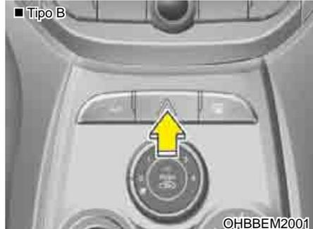
As luzes de advertência devem ser usadas sempre em situações de emergência, ou quando o veículo estiver parado no acostamento de uma estrada. Pressione o interruptor com o símbolo de um triângulo estando a chave de ignição em qualquer posição. O interruptor está localizado no painel de interruptores do console central. Todas as luzes indicadoras de direção irão piscar simultaneamente.
