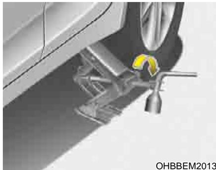
8. Encaixe a chave de roda no macaco e gire-a no sentido horário, levantando o veículo até que o pneu desencoste do solo. Essa medida é de aproximadamente 30 mm. Antes de remover as porcas da roda, certifique-se de que o veículo esteja estável e que não haja a possibilidade de se movimentar ou escorregar.
