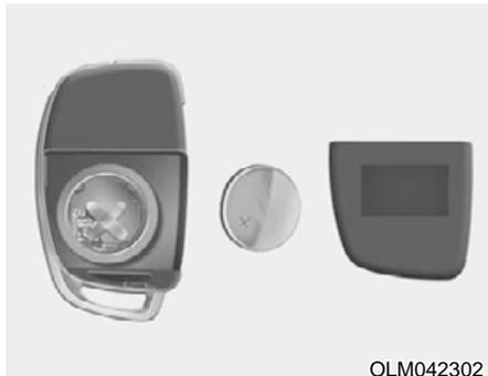
O transmissor utiliza uma bateria de lítio de 3 volts que normalmente irá durar vários anos. Quando a substituição for necessária, utilize o procedimento a seguir.
