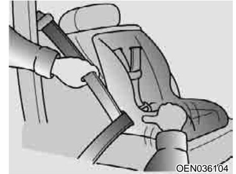
3. Afivele o cinto de segurança ajustando-o para que não apresente folga. Após a instalação do sistema de proteção para crianças, tente movimentá-lo em todas as direções para certificar-se que o equipamento esteja firmemente instalado.
