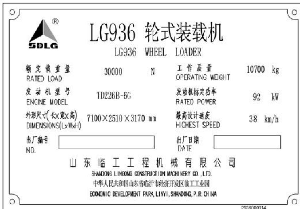
Figura 2-4 Plaqueta de Identificação da Carregadeira de Rodas LG936 montada com Conjuntos Padrão com Motor Diesel TD226B
