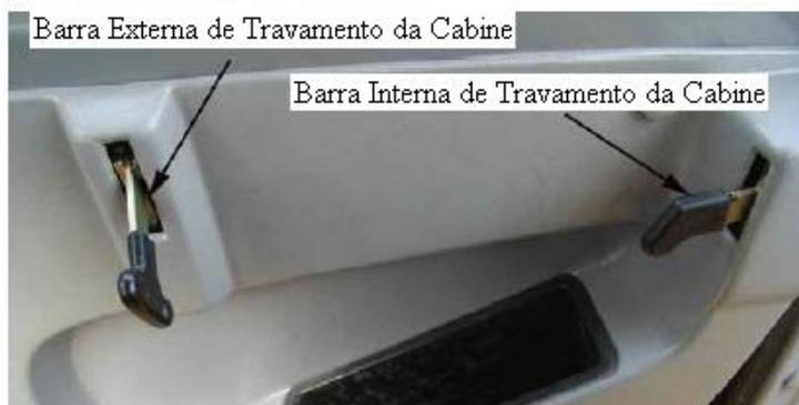
**Barra interna de travamento da cabine:** A porta será travada automaticamente após o seu fechamento. Inserir a chave na parte de fora da cabine, girá-la 180° no sentido horário e remover a chave, puxar a alavanca externa da cabine e a porta abrirá. Girar a barra de travamento para cima e a porta abrirá.
