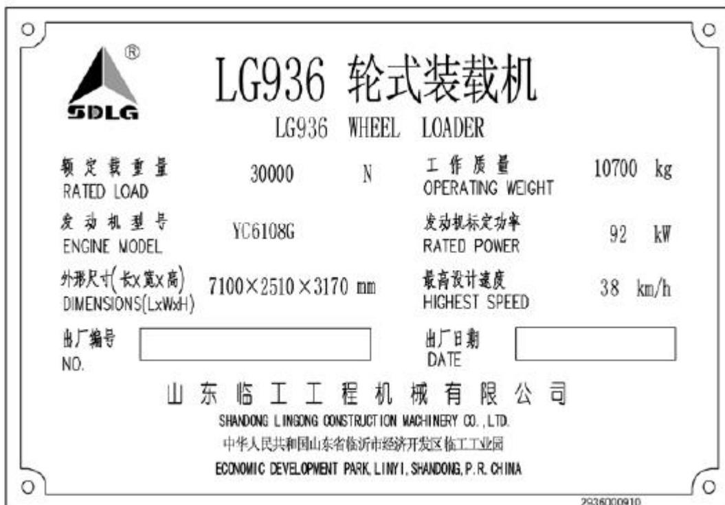
Figura 2-3 Plaqueta de Identificação da Carregadeira de Rodas LG936 montada com Conjuntos Padrão com Motor Diesel YC6108G
