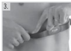
3. Afaste o transmissor do peito e humedeça as duas zonas com eléctrodos, que apresentam ranhuras, existentes na parte posterior.
