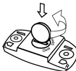
Abra a tampa apenas quando substituir a pilha para garantir uma longa duração e certifique-se de que o anel vedante não está danificado; caso contrário, deve substituí-lo por um novo.
