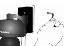
• Fixe a unidade à placa de montagem no orifício central com o parafuso inviolável usando a chave sextavada fornecida.
