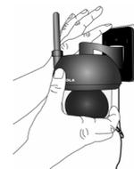
• Τοποθετήστε τις 4 σχισμές στερέωσης της βάσης κάμερας στα 4 άγκιστρα στη βάση τοποθέτησης. Βεβαιωθείτε ότι η μονάδα κάθεται σταθερά στη βάση τοποθέτησης με τις κεντρικές σπές των 2 τμημάτων ευθυγραμμισμένες.
