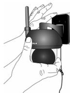
• Posizionare i 4 vani di montaggio della base della telecamera sui 4 fermi della piastra di montaggio. Assicurarsi che l'unità venga fissata saldamente alla piastra di montaggio con i fori centrali delle 2 parti allineati tra di loro.
