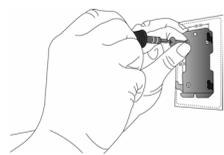
• Fixe a placa de montagem na parede com os 4 parafusos de cabeça philips (fornecidos).
