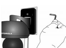
• Fije la unidad a la placa de montaje en el orificio central con el tornillo de seguridad utilizando la llave incluida.
