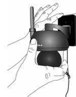
• Coloque las 4 ranuras de montaje de la base de la cámara en los cuatro enganches de la placa de montaje. Asegúrese de que quede firmemente fijada en la placa de montaje, con los orificios centrales de los dos elementos correctamente alineados.
