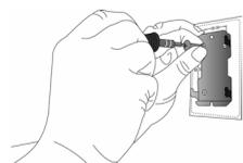
• Fissare la piastra di montaggio alla parete con le 4 viti a testa Philips (accluse).
