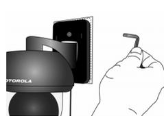
• Fissare l'unità alla piastra di fissaggio attraverso il foro centrale tramite la vite anti-manomissione utilizzando la chiave inglese fornita.
